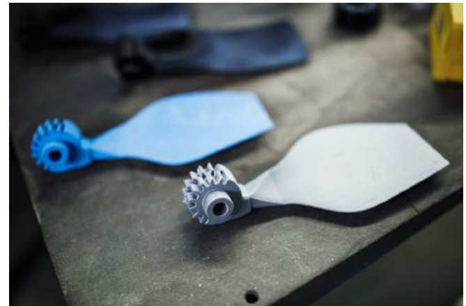
Sylatech 用于熔模铸造金属的 PLA 螺旋桨原型
