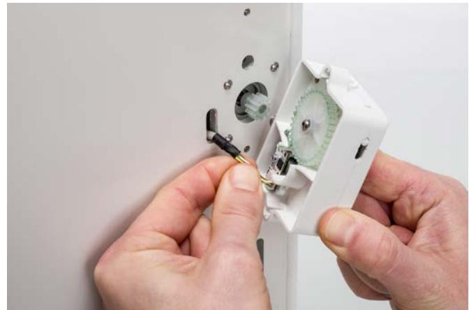
5. 用干净的抹布或棉签擦去进料装置齿轮上的所有耗材碎料和油脂残留物。清洁连接至电机的齿轮和进料装置内较大的齿轮。
