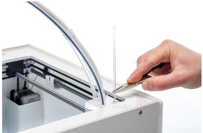
3. 剪掉刚刚拔出的耗材尖端。
