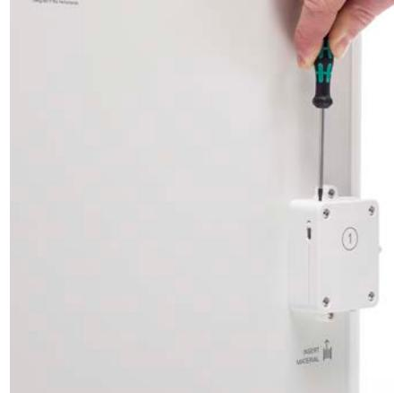
4. 使用六角螺丝刀松开进料装置外壳的四颗螺栓。
