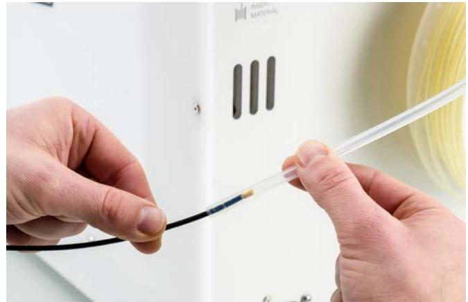
7. 将管耦合夹头按压到进料装置中，并一直推入鲍登管，从而将鲍登管插入进料装置。用夹片固定住管。对其他鲍登管重复此步骤。
