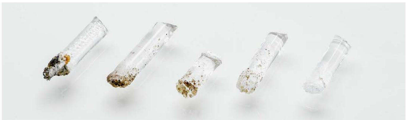
5. 重复此程序，直到清洁耗材尖端上再也看不到降解材料。耗材尖端应该像右侧的示例一样干净。
