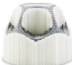
PVA (聚乙烯醇) 可以打印具有悬空, 空腔, 复杂几何形状的复杂模型, 然后将其溶解。
