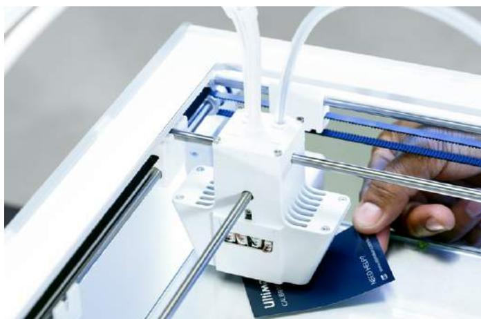
利用第一个喷嘴校准好打印平台板之后，第二个喷嘴也需要对齐，以确保两个喷嘴的高度设置正确。为此，只需利用校准卡设置正确的高度即可。
