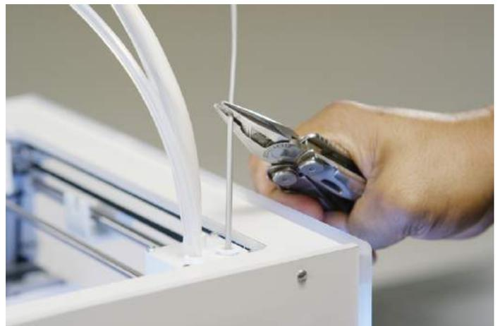
5. 检查拔出的材料尖端的颜色和形状。将其与下图对比，看看是否正确。如果不正确，重复上述过程。
